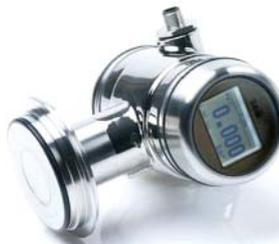
Головка прецизионного датчика с дисплеем для индикации и параметрирования установлена на ножке из нержавеющей стали, внутри которой размещен терморезистор для компенсации измеренных значений. Электронный прибор в головке датчика распознает это изменение и преобразует его в сигнал 4...20 мА.
