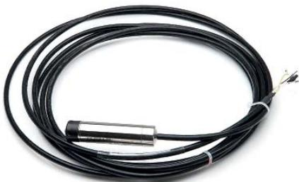
Промышленный датчик измерения давления в скважинах и водоемах. Диапазон эффективных измерений от 0...40 мбар до 0...25 бар, что соответствует измерениям на глубине до 250 м от зеркала воды. Точность согласно IEC 60770 — 0,35%. Благодаря измерительному элементу из высококачественной нержавеющей стали датчик отличается своими измерительными свойствами.
