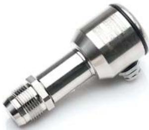
Датчик в гигиеническом исполнении с функциональной температурой до 110 °С при CIP-мойке до 140 °С в течение получаса был разработан на базе датчика SDT02, но с погрешностью измерений 0,2%. Номинальное измерение давления — до 40 бар. Варианты исполнения с соединительной головкой и без нее.
